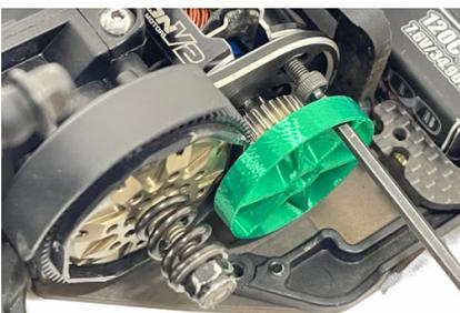
モータにピニオンを取り付けてからモータを固定するとサイドガードを削らなくても装着できます。
